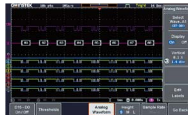
數位訊號轉換為類比波形的顯示
