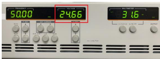
圖 8.19 將 APS-300 電壓調至 24.66V
