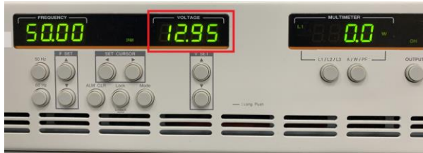
圖 8.25 將 APS-300 電壓調至 13V
