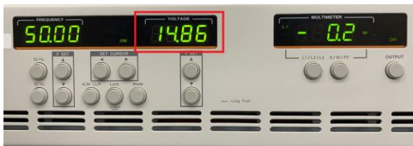
圖 8.22 將 APS-300 電壓 調至 14.86V
