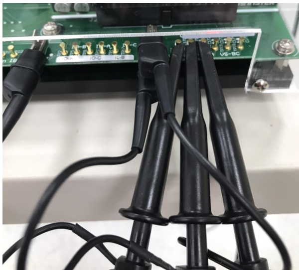
圖 6.8 示波器探棒接線圖
