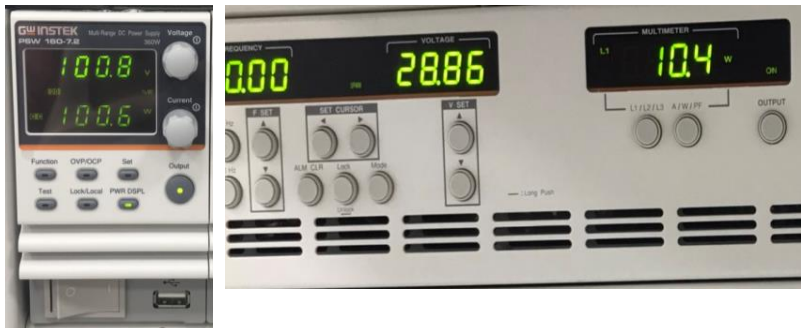
圖 3.21 半載下 PSW 與 APS-300 的功率狀態
