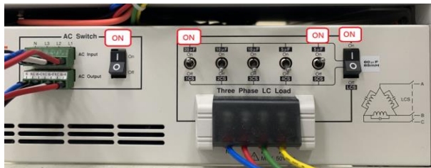
圖 5.17 微調負載電容(並聯 5uF)
