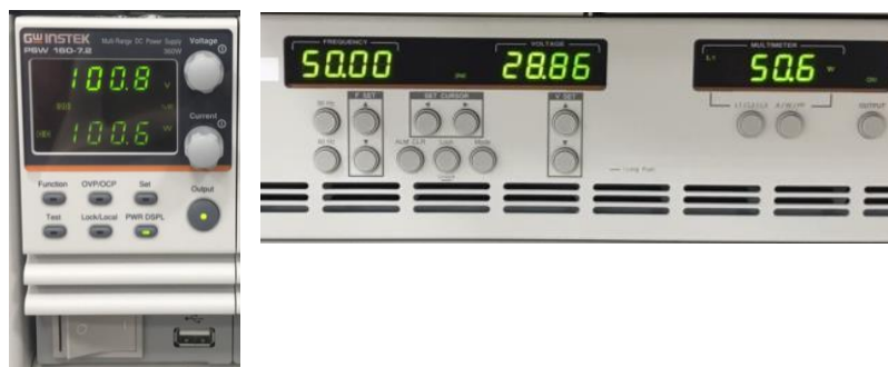
圖 3.23 滿載下 PSW 與 APS-300 的功率狀態
