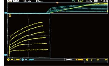
提供帶有讀出刻度的 I-V 特性曲綫 (曲綫跟踪器)。我們使用 MPO-2000 來實現曲綫跟踪器功能應用程序。XY 模式用于進行波形累加 (如下圖所示)。用戶可以使用 MPO-2000 的兩個內置 20V 直流電源供電。專業版可以通過 USB CDC-ACM 控制外部直流電源供電。
