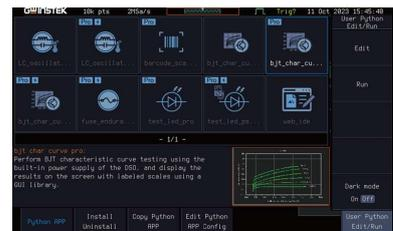
如果用戶想要修改或調用繪圖庫的腳本，他們必須購買 Pro 版本來自行修改程序，以滿足不同 DUT 的測試。此外，其他制造商也可以使用示波器內置的 AWG 功能來達到類似的效果，但這種 AWG 的電壓和功率太小，實用性較低。單個 MPO-2000 可以滿足適用於 20V 以下電壓的零件的 IV 測試要求。
